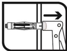
Schraubenkopf in die Montagepistole einsetzen. Pistole betätigen, bis der Dübel vollständig gespreizt ist, nicht herausziehen.
