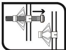
Pistole entfernen und Schraube herausdrehen.
