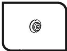
Mit einem Hammer sanft klopfen, bis die Riffel am Kopf im Grundmaterial greifen.
